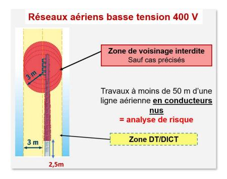
Schéma des réseaux télécommunication implantés sur des supports communs de lignes électriques basse tension non isolées (ou indépendants implantés dans la zone de voisinage simple).
