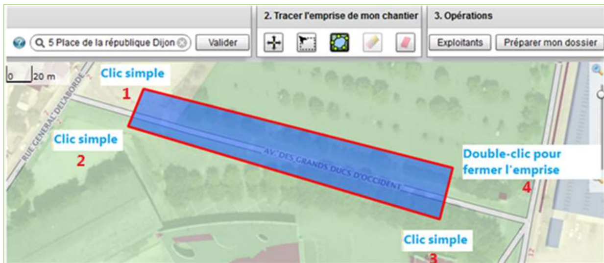
Figure 6 - Tracer l'emprise de chantier
